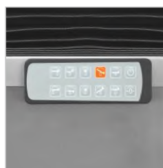
Резервный пульт управления на колонне
